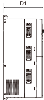
380V 45~75kW壁挂安装示意图
