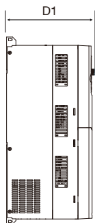
380V 45~75kW壁挂安装示意图
