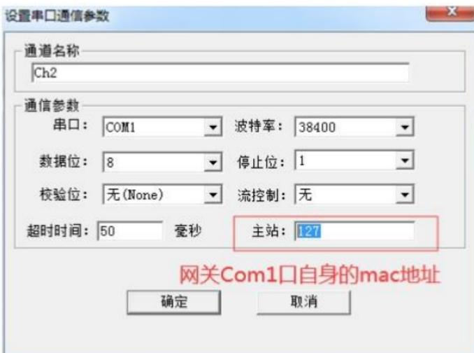
通道建立好后, 选择新建设备, 在弹出来的对话框中设置设备属性, 站号即设备 ID 号, 用户可以通过 BACnetScan 自动扫描来查询总线上有哪些设备在线, 请求帧间隔为 50 毫秒, 如下图所示。
