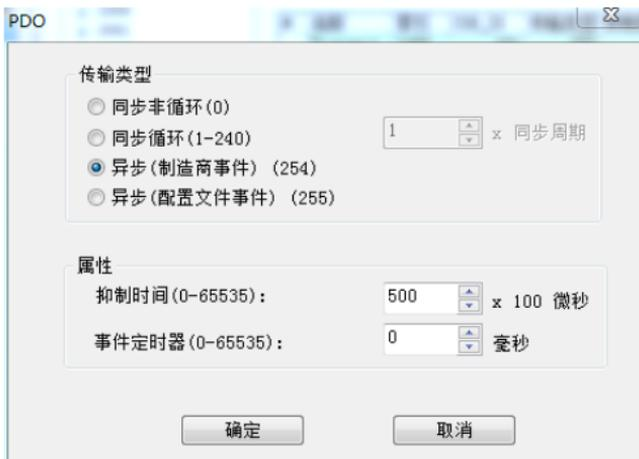
PDO 接收支持所有传输模式，一般 PDO 接收 1 组态为 254 模式，并加一个合适的抑制时间，PDO 接收 2~4 组态为同步模式，根据通讯数据的实时性要求，组态为不同的同步模式。如下界面，组态 PDO 接收 1 传输模式 254，抑制时间 50ms。
