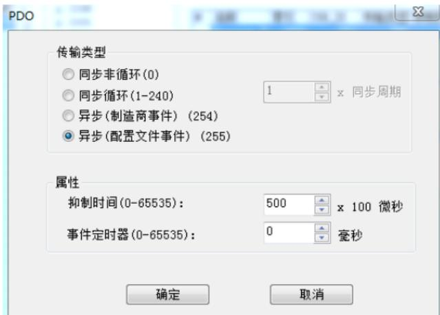
详见 GD350 变频器 CANopen 通讯部分说明，PDO 发送 1 只支持 255 传输模式，且不支持事件定时器模式，因此这里组态 PDO 接收 1 模式为异步 255 模式，“事件定时器”事件时间组态为 0ms，“抑制时间”组态为 50ms，即 50ms 内，最多发送一次 PDO 发送 1 报文。
