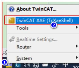
打开 TwinCAT3 软件后，选择菜单文件 (F) → 新建 (N) → 项目 (P)，在弹出对话框新建项目中选择左侧 Template 下的 TwinCAT Project，给定解决方案名称和存储路径后点击“确定”完成新建。
