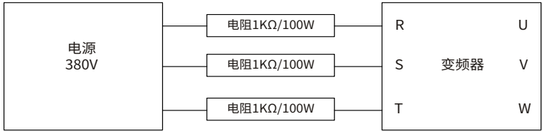
图 9-1 380V 驱动装置充电电路示例
