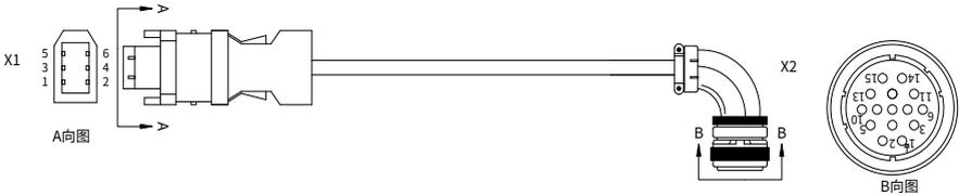
表 4-6 驱动器侧 X1 和绝对式编码器电机侧 X2 的接线端子说明
