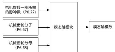
$$\text{模态轴模数} = \text{电机旋转一圈所需的脉冲数 (P0.22)} \times \frac{\text{机械齿轮分子 (P6.67)}}{\text{机械齿轮分母 (P6.68)}}$$
