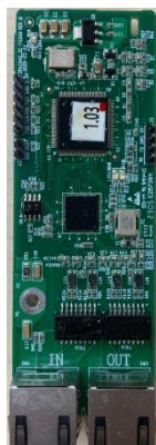
EtherCAT 通讯卡 EC-TX508B
