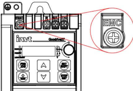
图 4-2 D、E 箱体 EMC 螺钉
