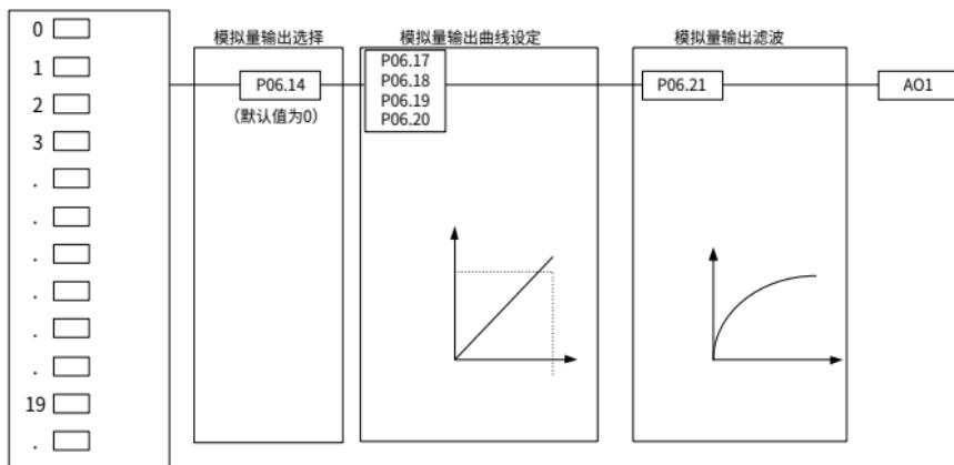
AO1 输出对应关系说明（输出值的最小值和最大值分别与默认输出 0.0% 和 100.0% 对应。实际输出电压与实际的百分比相对应，百分比通过功能码可设定）。输出功能详情如下：
