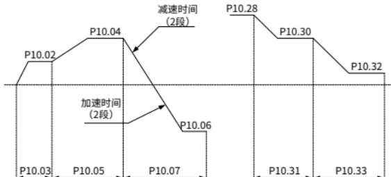
注意: 多段速的符号决定了简易 PLC 的运行方向, 负值表示反向运行。加速时间指变频器从 0Hz 加速到最大输出频率 (P00.03) 所需时间。减速时间指变频器从最大输出频率 (P00.03) 减速到 0Hz 所需时间。用户选择相应段的加、减速时间以后, 把组合的 16 位二进制数换算成十六进制数, 设定相应功能码即可。
