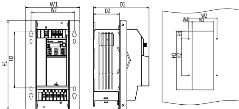
表 C-5 外形结构 C 的尺寸和孔位 (单位: mm)
