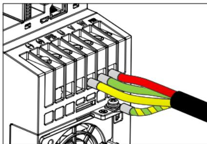
步骤3 将带电缆的制动电阻等选件连接到指定位置。详情请参见 4.3.1 电缆选型。
