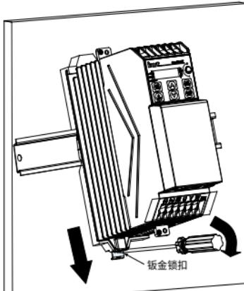
步骤 2 同时向里用力按压导轨支架中间的卡扣，再向外拉出导轨支架 1 和 2。
