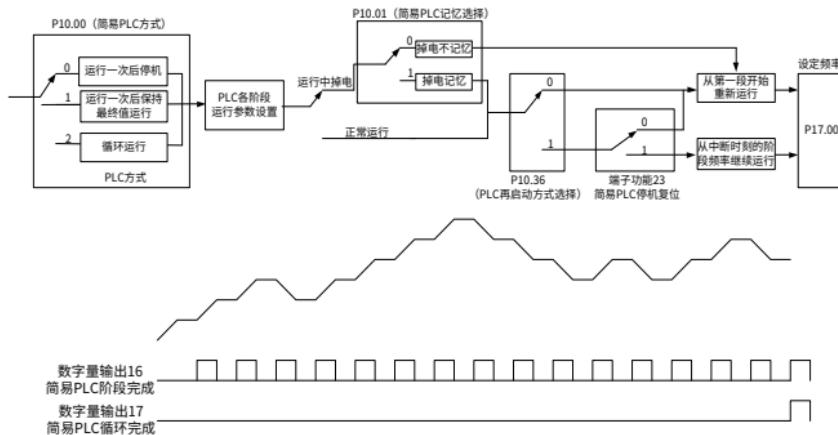
简易 PLC 作为给定频率时, 需要设定参数 P10.02~P10.33 来确定其各段的运行频率和运行时间, 参数图如下:
