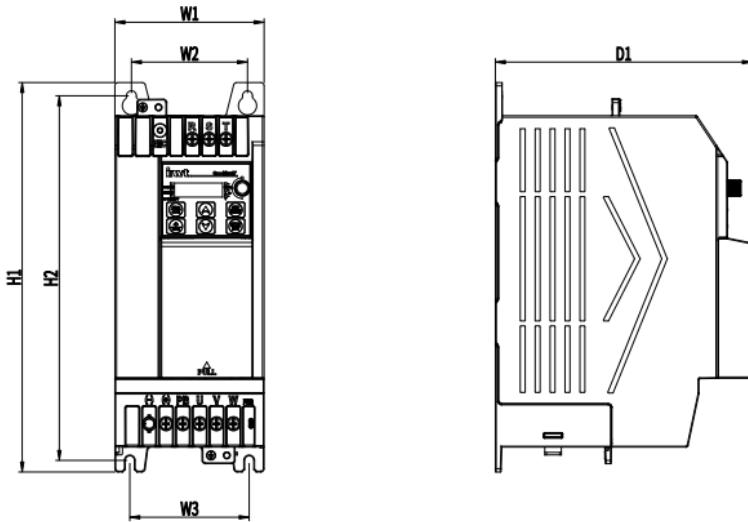
表 C-2 外形结构 C 的尺寸和孔位 (单位: mm)
