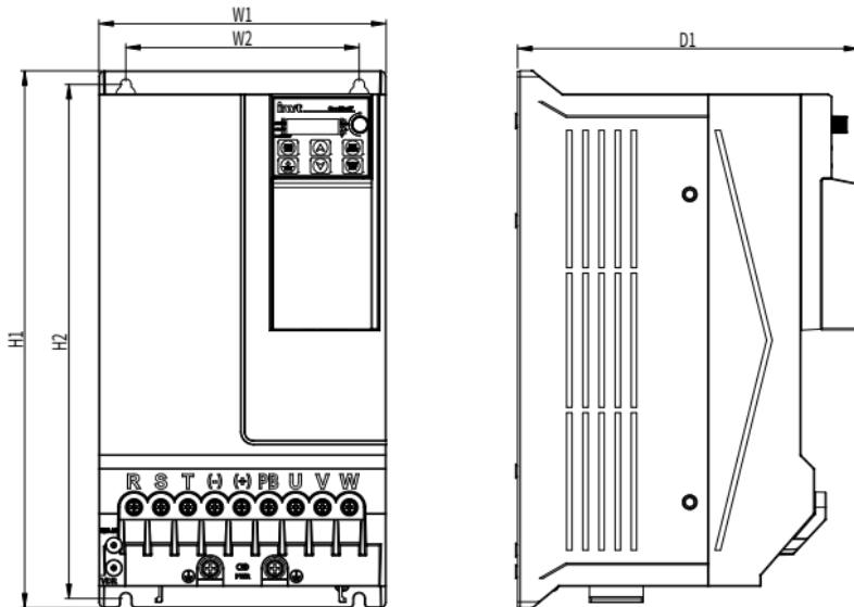
表 C-4 外形结构 E 的尺寸和孔位 (单位: mm)
