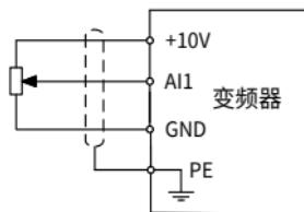
图 4-16 PE 屏蔽层接线
