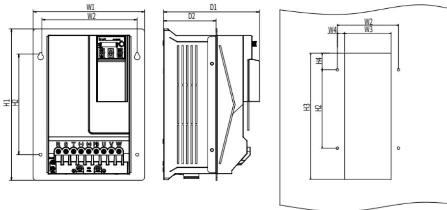
表 C-7 外形结构 E 的尺寸和孔位 (单位: mm)
