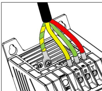
步骤2 将电机电缆的黄绿色接地线连接到变频器的接地端子，将电机三相电缆连接到端子 U、V 和 W，并紧固。
