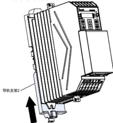
步骤 3 扣紧导轨支架 1 和 2。（确保卡扣到位，且钣金锁扣处于下拉位置）
