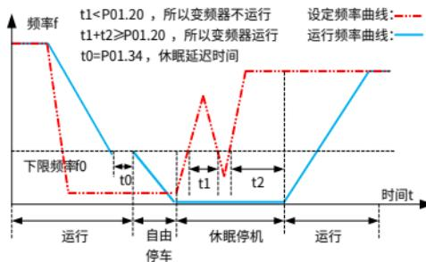
当设定频率低于下限频率，P01.19 个位选择休眠待机，变频器保持下限频率运行 P01.34 时间后，按照 P01.19 的十位设定的停机方式停机，进入休眠状态。当设定频率再次大于下限频率时，且持续时间超过 P01.20 所设的“休眠恢复延时时间”，变频器自动恢复运行状态，运行到设定频率。
