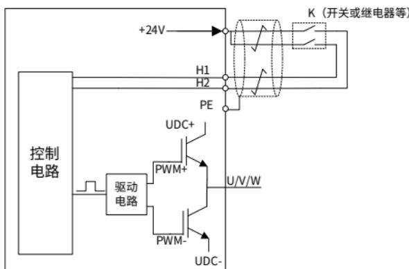
图 E-3 STO 功能电路外部电源接线
