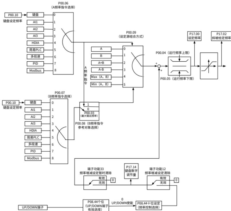
设置 P05.01/P05.02 为 10/11 时，则 S1/S2 为 UP/DOWN 端子。闭合 S1/S2 时，给定频率将快速递增/递减，递增/递减的快慢由 P08.45/P08.46 决定。示意图如下：
