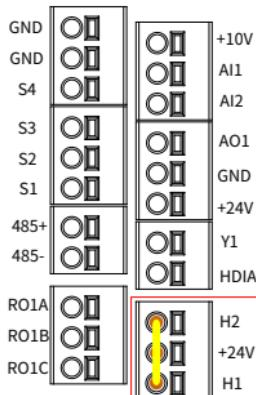
图 E-2 STO 功能电路内部电源接线
