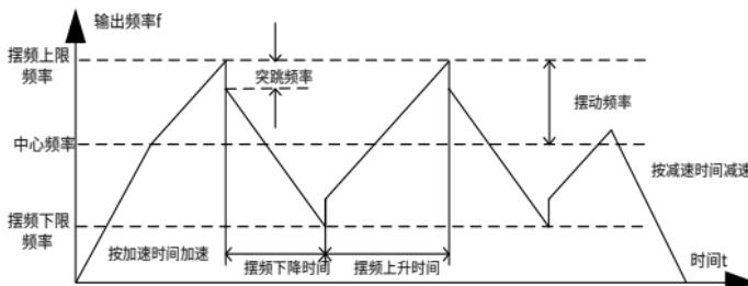
$$\text{摆动频率} = \text{中心频率} \times \text{摆频幅度 P08.15}$$
