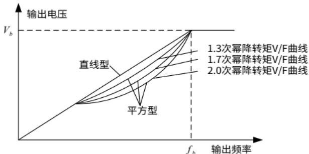
注意：图中的  $V_b$  对应为电机额定电压、 $f_b$  对应为电机额定频率。
