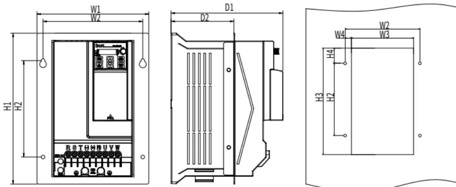
表 C-6 外形结构 D 的尺寸和孔位 (单位: mm)
