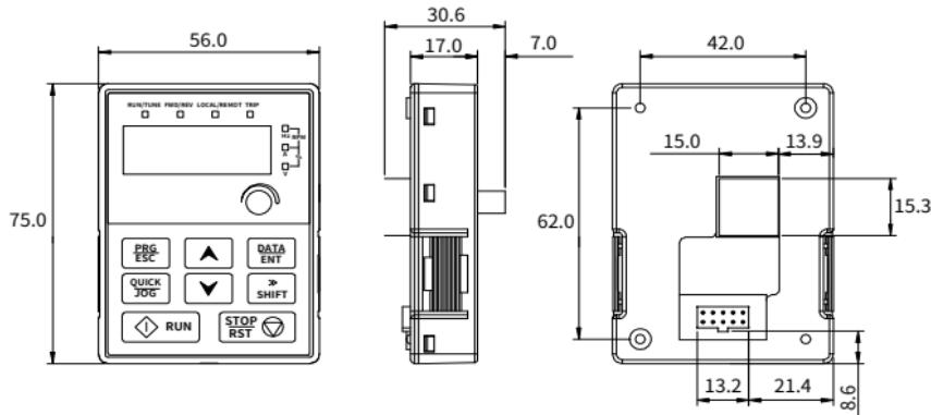
图 D-5 键盘无支架开孔(单位:mm)
