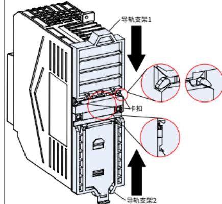
步骤 4 将带支架变频器垂直安放至导轨上，并将钣金锁扣往上推使其与导轨紧扣。
