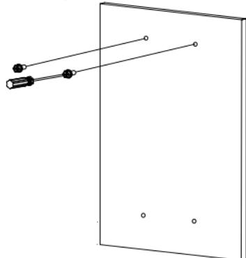
步骤 2 将变频器带葫芦孔的一端扣在预紧的两颗螺钉上。
