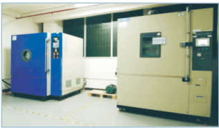
低气压测试箱 (左), 恒温恒湿测试箱 (右)
