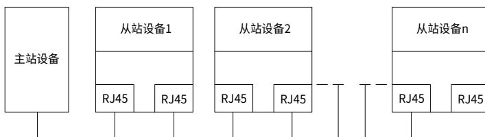
图 E-20 星型网络拓扑电气连接
