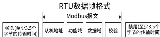
一帧信息必须以一个连续的数据流进行传输，如果整帧传输结束前有超过 1.5 个字节以上的间隔时间，接收设备将清除这些不完整的信息，并错误认为随后一个字节是新一帧的地址域部分，同样的，如果一个新帧的开始与前一个帧的间隔时间小于 3.5 个字节时间，接收设备将认为它是前一帧的继续，由于帧的错乱，最终 CRC 校验值不正确，导致通信故障。
