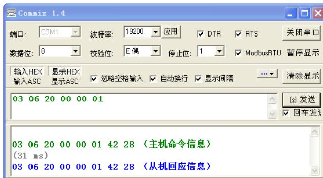
首先将“串口”选择 COM1。波特率要与 P14.01 设置一致。数据位、校验位、停止位一定要与 P14.02 中设置的一致。因为使用的是 RTU 模式，所以选择十六进制的“HEX”。要软件自动加上 CRC，一定要选上  ModbusRTU，并且选择 CRC16 (ModbusRTU)，起始字节为 1。一旦能了自动加 CRC 校验，在填指令时就不要再填 CRC 了，否则会重复而导致指令错误。
