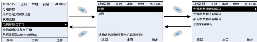
选择电机自学习类型后，进入电机参数自学习界面，按 **RUN** 键开始电机参数自学习过程，自学过程完毕后会提示自学习成功，然后返回停机主界面显示。自学习过程中可以按 **STOP/RST** 键可终止自学习过程；如果自学习过程中出现故障，则键盘会弹出故障界面。
