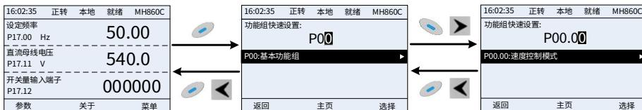
键盘进入和退出系统菜单和显示层次的操作关系：
