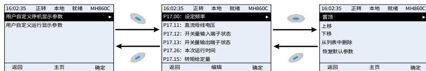
按“编辑”键 进入编辑界面，选择需要的操作，按“确定”键 或“回车”键 均可确认编辑操作并返回上一级菜单（参数列表），返回的列表已是编辑完成后的参数列表。在编辑界面未选择编辑操作而按“返回”键 取消编辑并返回上一级菜单（参数列表未更改）。
