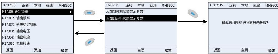
按“添加”键 进入添加界面，选择需要的操作，按“选择”键 或“回车”键 均可确认添加操作，若原“停机状态显示参数”列表或者“运行状态显示参数”列表中没有此参数，则添加的参数在“停机状态显示参数”列表或者“运行状态显示参数”列表中的位置为表尾；若原“停机状态显示参数”列表或者“运行状态显示参数”列表中已有此参数，则列表不再添加此参数。在“添加”界面未选择添加操作而按“返回”键 取消添加并返回监控参数列表菜单。
