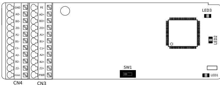
SW1: 拨码开关，用于选择编码器供电电压等级（5V 或 12V），拨码开关可借助辅助工具操作。
