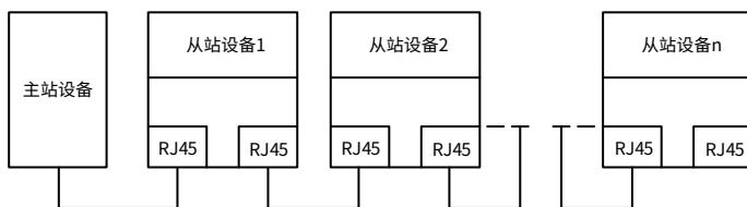
图 E-8 星型网络拓扑电气连接
