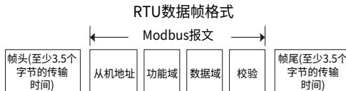
一帧信息必须以一个连续的数据流进行传输，如果整帧传输结束前有超过 1.5 个字节以上的间隔时间，接收设备将清除这些不完整的信息，并错误认为随后一个字节是新一帧的地址域部分，同样的，如果一个新帧的开始与前一个帧的间隔时间小于 3.5 个字节时间，接收设备将认为它是前一帧的继续，由于帧的错乱，最终 CRC 校验值不正确，导致通信故障。
