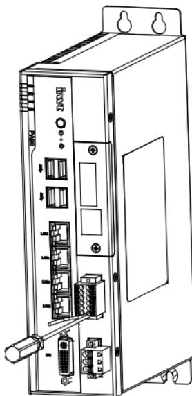
接线操作：将制作好的线缆端子头直接插入端子中。
