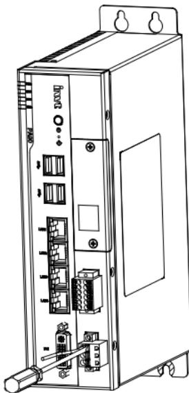
接线操作：将制作好的线缆端子头直接插入端子中。
