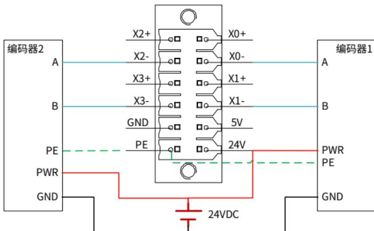
图 B-3 单端输入接线图 (PNP 型)
