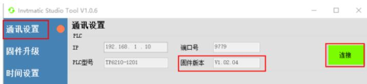
步骤3 再依次选择：“固件升级”→“选择升级文件”→“开始升级”，进行固件升级。待下方状态栏显示进度 100%后 PLC 自动重启，完成升级。
